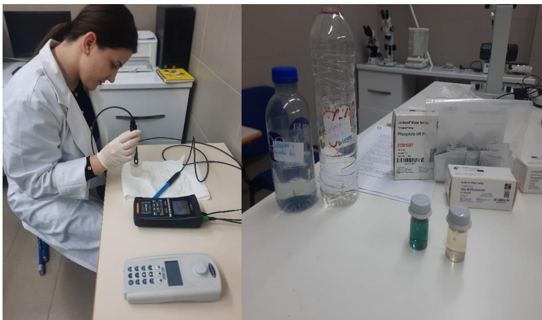
Slika 3. Određivanje TDS, saliniteta i pH vode, te priprema uzorka sa reagensima (autori)
